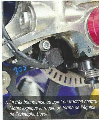
^ La couronne et son support restent fixés au bras, cela permet des changements de roue éclair. Notez la forme spécifique du moyeu (en rouge) dans lequel vient s'emboîter la jante.
